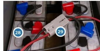
**PRECAUCION:** No arroje las baterías dentro del compartimiento. Puede causar daño a la batería y/o a los bornes. Estos daños no están cubiertos por la garantía.
