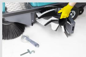
3. Desgaste de los cepillos central y lateral. Si es necesario reglarlas correctamente o sustituir las.
