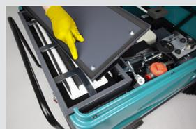
4. Comprobación de que las guarniciones de cierre de los contenedores estén intactas y en buenas condiciones.
