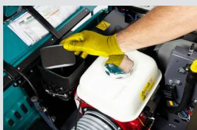
1. Limpieza del filtro del aire del motor.
