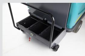
6. Colocar en la máquina el contenedor de los residuos.
