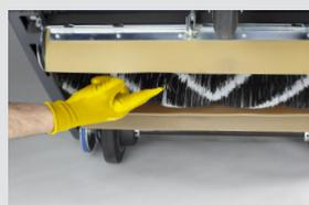
3. Desgaste de los cepillos central y lateral. Si es necesario reglarlos correctamente o sustituirlos.
