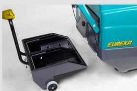
5. Colocar en la máquina el contenedor de los residuos.
