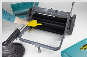
2. Desgaste de los cepillos central y lateral. Si es necesario reglarlos correctamente o sustituirlos.
